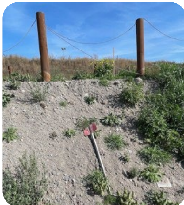
Försök med att rena DDT-förorenade massor med elektrokinetik. Foto: Karin Eliaeson.
